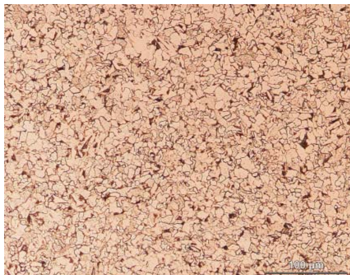
Obr. 7 – Nově použitý materiál QStE380 je jemnozrný a bez sulfidických vměstků. Tato změna iniciovala požadované zlepšení střižné plochy a následně i galvanické vrstvy.
