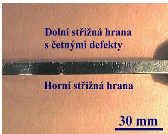
Obr.3 - Nová verze klíče (tj. po úpravě stříhání) u nějž byly opět sledovány defekty na rovných plochách při dolní střížné hraně.
